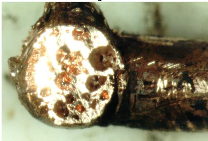
Figura 07 – Condutor de cobre – Traço de fusão secundário com corte longitudinal.
