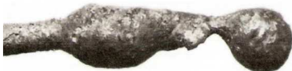
Figura 12 - Visão microscópica da extremidade de um fio de cobre fundido por aquecimento incêndio localizado.
