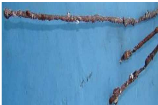
Figura 11 - Fusão de condutor não energizado pela ação do fogo.
