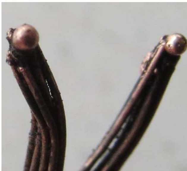
Figura 18 – Traço de fusão primário localizado no condutor do ventilador de teto.
